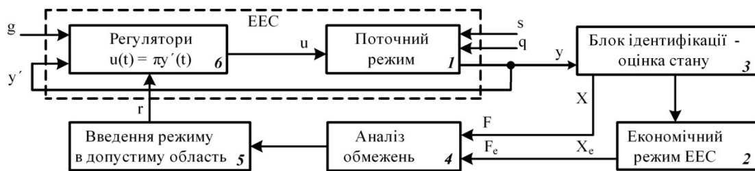
Рисунок 3 - Адаптивна система оптимального керування нормальним режимом ЕЕС
