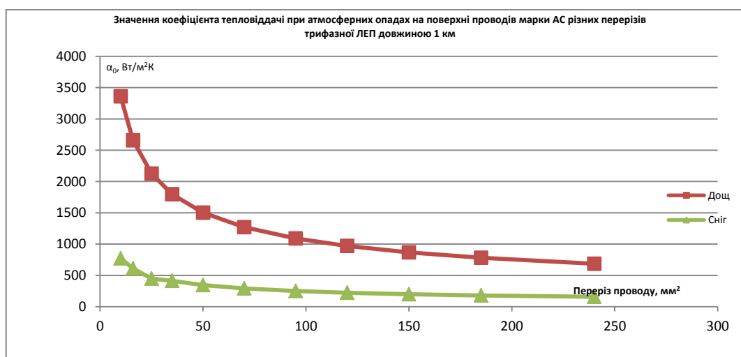
Рисунок 1 - Значення коефіцієнта тепловіддачі при атмосферних опадах на поверхні проводів марки АС різних перерізів повітряної ЛЕП довжиною 1 км
