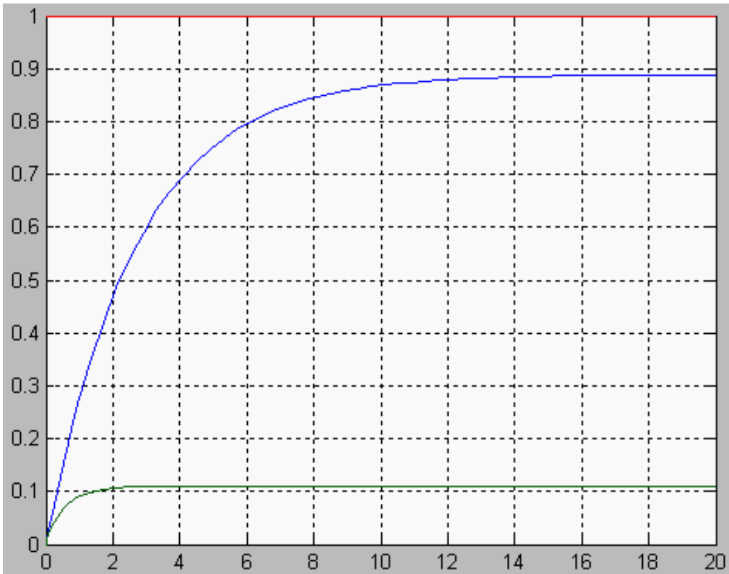
Рисунок 2.4. Процессы в нелинейной и линеаризованной системах при входном воздействии u = 1 .
