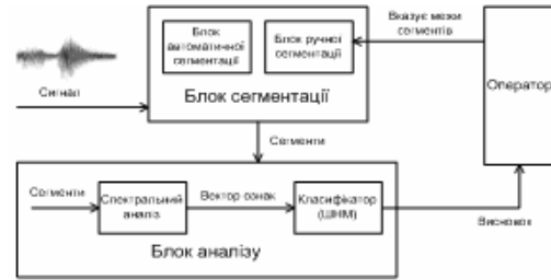
Рисунок 19 – Загальна схема програмного комплексу підтримки фіксації результатів випробувань вибухових речовин
