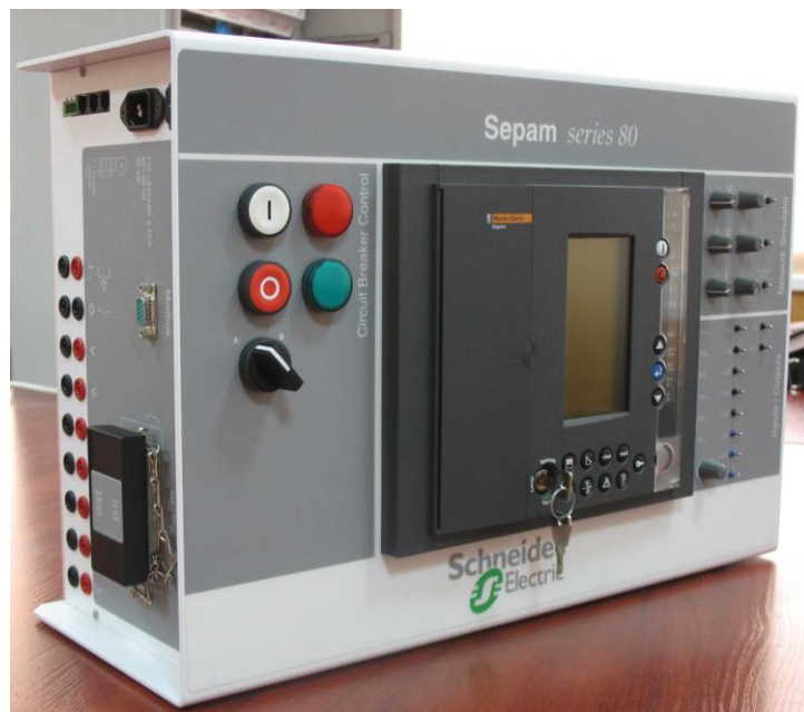
Рисунок 3 – Стенд для изучения средств микропроцессорной релейной защиты Sepam 80
