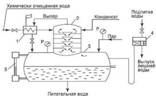
Рисунок 3 – Принципиальная схема установки термического деаэратора
