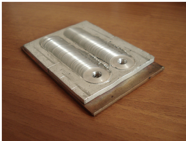
Рисунок 3 – сварное соединение меди с алюминием, полученное способом СТП.
