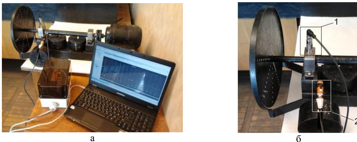
Рисунок 2 – Внешний вид лабораторного роторного стенда и диагностического комплекса VSE Efactor Octavis (а), а также расположение датчиков (б)
