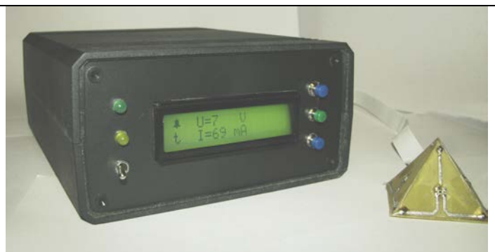
Рисунок 9 – Пульт керування системою автоматичного повороту фотопанелі за Сонцем
