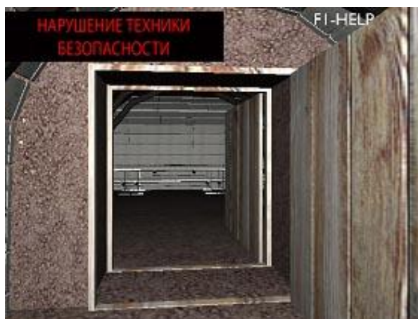
Рисунок 1 – Реализация обучающего сценария в ознакомительном режиме с фиксацией нарушений правил безопасности (в данном случае: одновременное открытие нескольких дверей в вентиляционном шлюзе)
