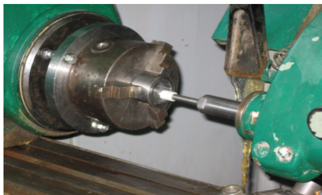
Рис. 2. Общий вид процесса обработки ВЦП изделия на станке модели 3Э110М
