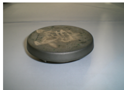
Рис. 3. Общий вид катода установки ННВ 6.6-И1, отработавшего 10 часов
