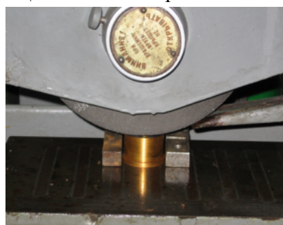
Рис. 7. Общий вид шлифовки поверхности изделия с ВЦП по сечениям
