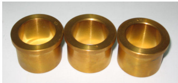
Рис. 4. Натурные образцы направляющих втулок (подложка - сталь 45)
