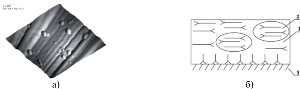
Рис. 2. Морфология (а) и схема строения (б) покрытий из фторсодержащих олигомеров «Фолеокс» на подложке из стали 45 термообработанных при 523 К (а,б)
