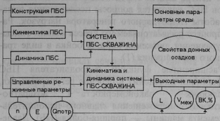
Рис.1. Структурная схема процесса однорейсовой проходки скважины погружными гидроударными буровыми снарядами: E — энергия удара; n частота ударов бойка; Q_{потр} — интенсивностью восходящего движения воды в керноприемнике ПБС
