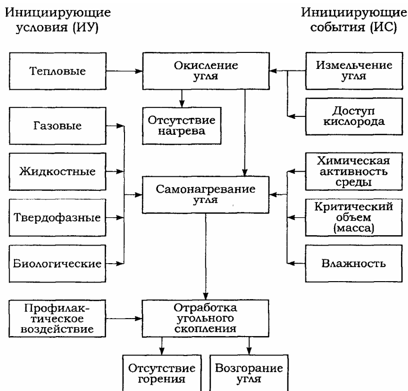
Рис. 11.1. Схема зарождения и развития очага самонагревания угля
