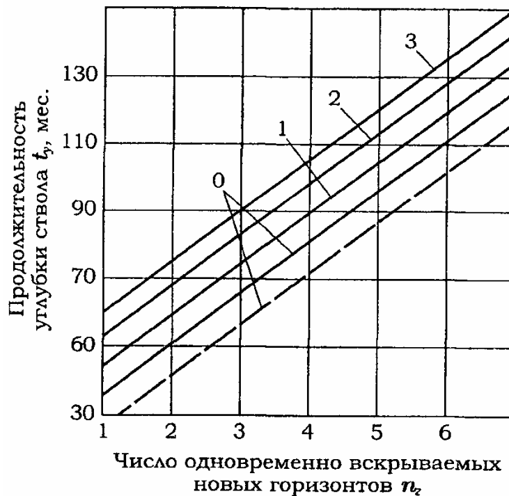
Рис. 3.16. График продолжительности углубки ствола в зависимости от числа одновременно вскрываемых новых горизонтов: 0, 1, 2, 3 - число пластов, вскрываемых стволом
