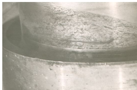
Рисунок 2 - Общий вид зоны фреттинг-процесса на валу компрессора
