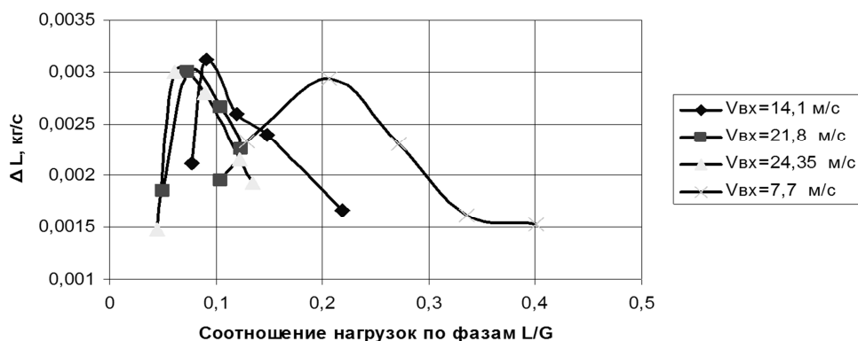
Рис. 3. Изменение брызгоуноса жидкости, в зависимости от соотношения нагрузок по фазам, при различной начальной скорости газа V (м/с), D_k=1100 мм, L – нагрузка по жидкой фазе (кг/с), G – нагрузка по газовой фазе (кг/с).
