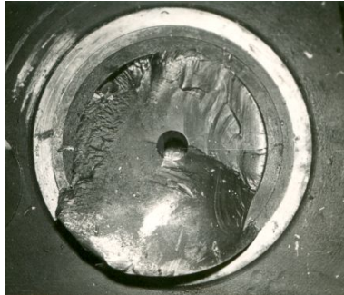
Рисунок 1 - Общий вид усталостного разрушения вала компрессора (вид со стороны щеки)
