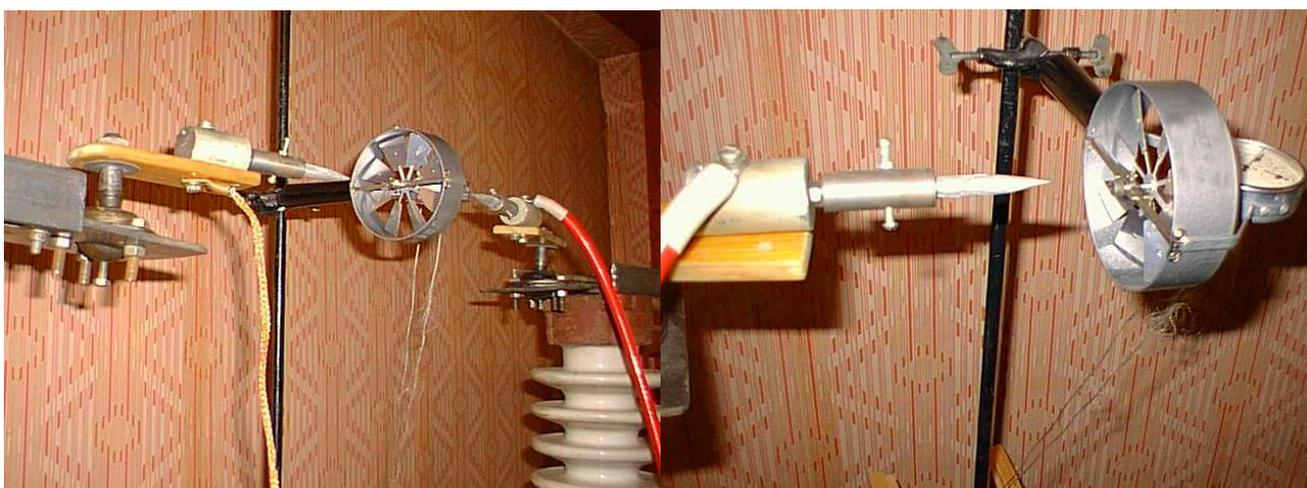
Рисунок 1 – Измерение скорости при помощи анемометра АСО-3
