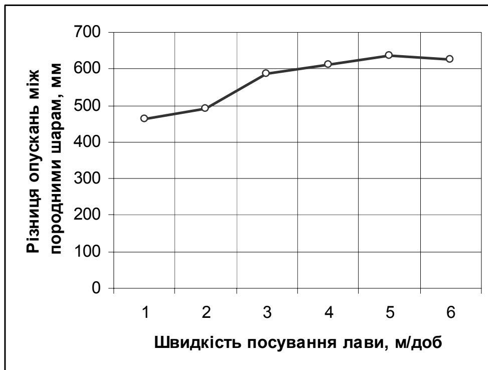
Рис. 2. Залежність висоти порожнини розшарування породного масиву від швидкості посування лави
