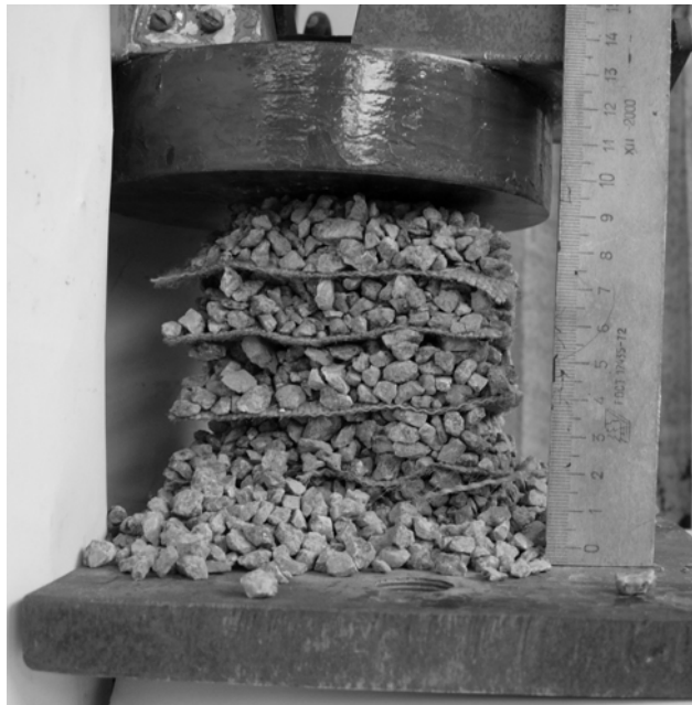
Рис. 4. Общий вид разделенной породной опоры.
