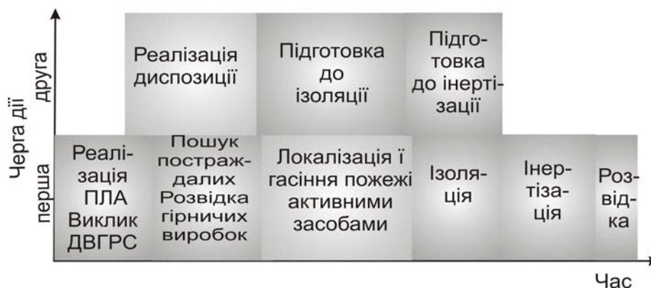
Рис. 2. Спрощена схема послідовності дій при веденні аварійно-рятувальних робіт з ліквідації пожежі у важкодоступному місці
