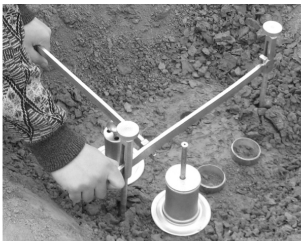
Рис. 1 - Отбор образцов грунта
