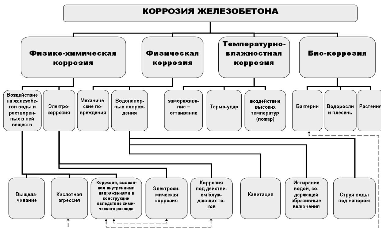
Рис. 1 – Классификация коррозионных процессов в железобетоне
