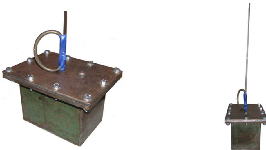
Рис.1 - Установка для определения объёмного расширения бетонной смеси.
