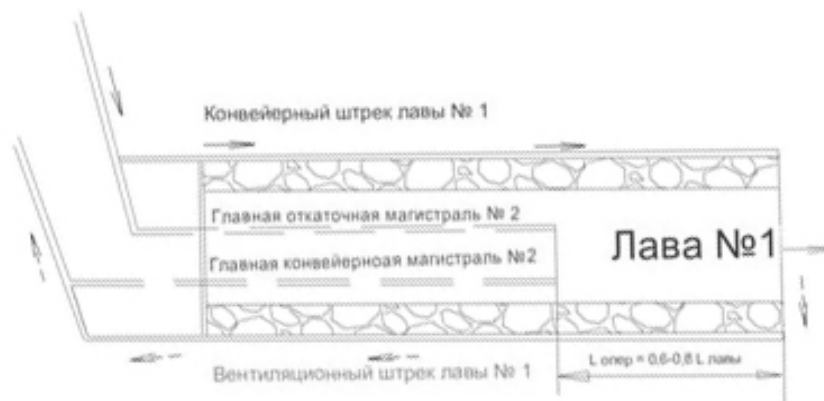
Рисунок 1 – Схема системы разработки коренной разгрузочной лавы.
