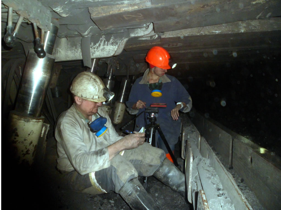
Рис. 3. Измерение смещения краевой части угольного пласта лазерным дальномером Leica Disto D3a
