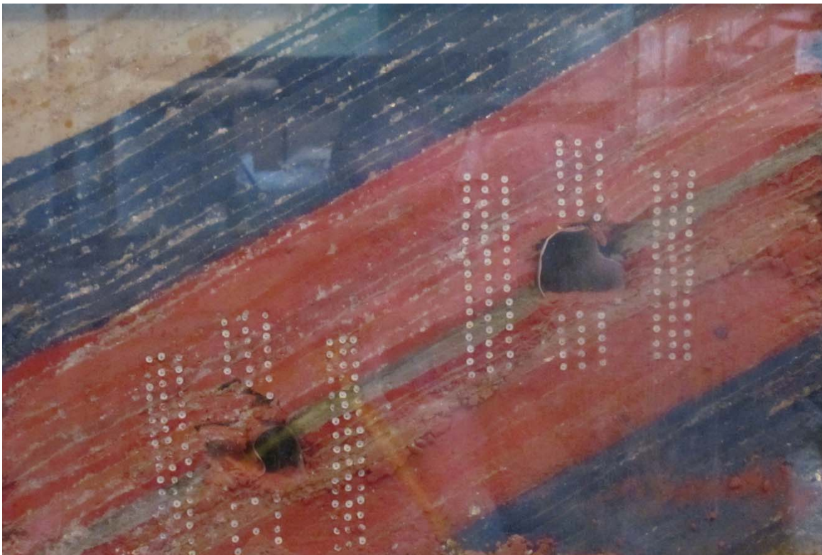
Рис. 4. Состояние выработок в модели: а – до начала испытаний; б – после испытаний
