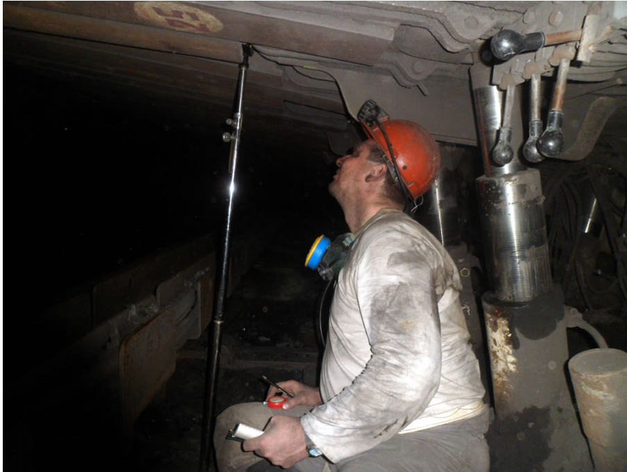
Рис. 2. Измерение конвергенции вмещающих пород стойкой СУИ-II с индикатором часового типа ИЧТ-0,01
