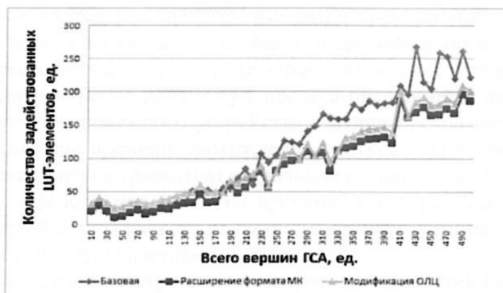
Рис. 2. Аппаратурные затраты для различных структур КМУУ в базе Spartan6 при интерпретации ГСА с 80 % операторных вершин
