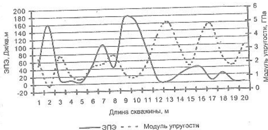
Рис. 3 - Изменение прогнозных показателей в конвейерном квершлага на пласт I 1 гор. 986 м блока №2 шахты им. А.Г.Стаханова
