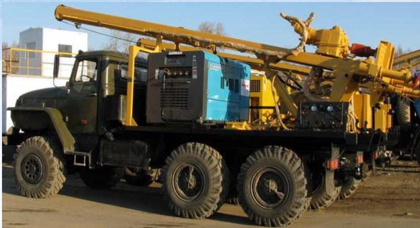
Бурова установка ПБУ-1
