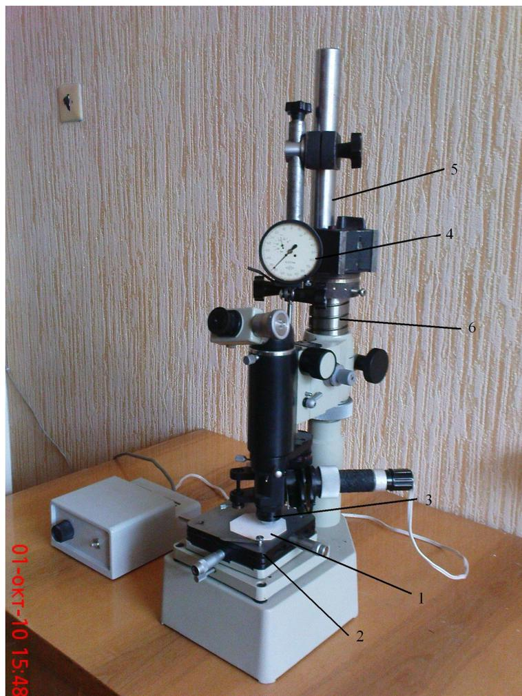
Рис. 1. Мікротвердомір ПМТ-3, оснащений для вимірювання розмірів зерен залізо-абразивного порошку
