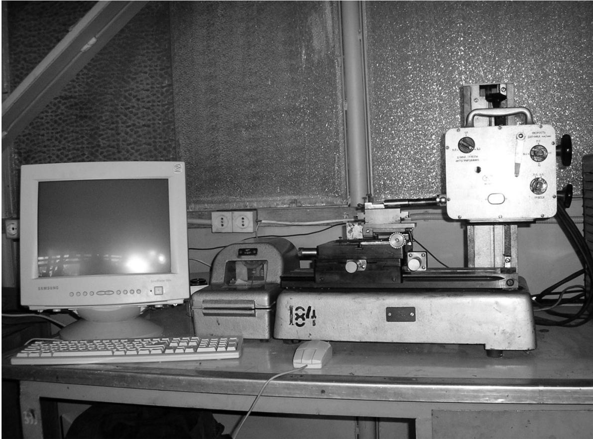
Рис. 2. Общий вид комплекса для записи профилограммы обработанной поверхности на ПЭВМ
