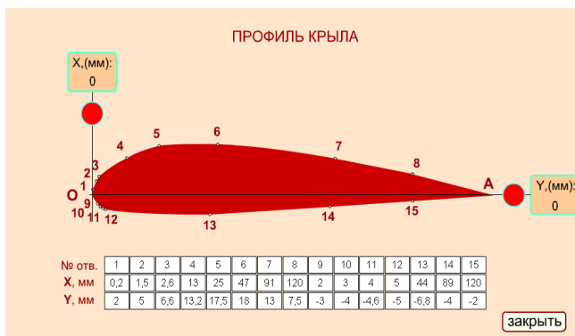
Рис. 2.12. Розріз профілю крила
