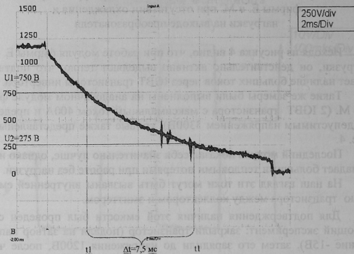
Рисунок 6 – Осциллограмма разряда IGBT транзистора на R_{разр}=124 \text{ Ом}
