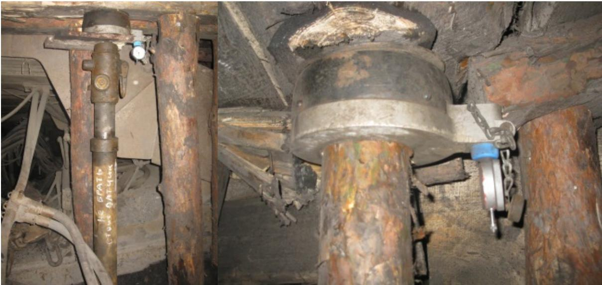
Рис. 10. Измерение нагрузки действующей на охранное сооружение
