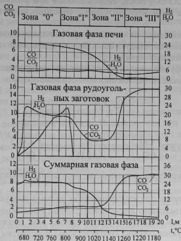
Рисунок 4 - Восстановительная способность газовой фазы по длине печи восстановления
