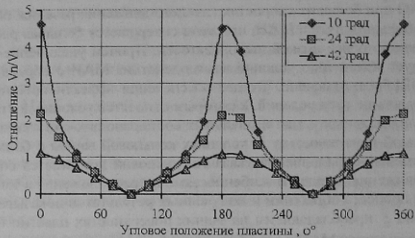
Рис. 3. Изменение отношения V_n/V_\tau нормальной и тангенциальной составляющих суммарной скорости движения на задней поверхности МНТП в зависимости от углового положения пластины при скорости главного движения 3 м/с для различных значений \xi
