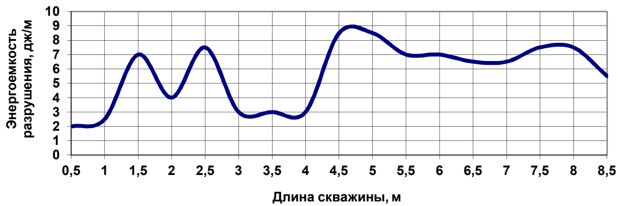
Рис.3 Изменения энергоемкости разрушения по длине скважины
