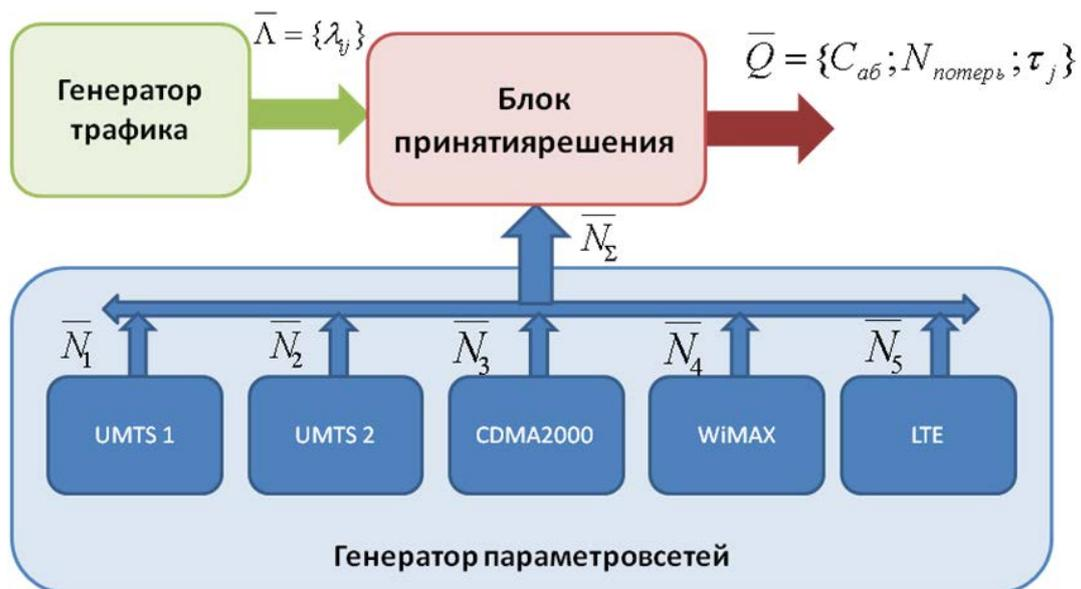
Рисунок 2 - Схема имитационной модели
