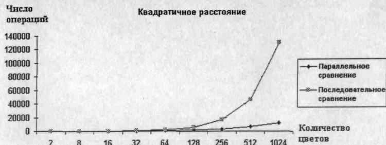
Рис. 2 Зависимость временной сложности вычисления квадратичного расстояния между гистограммами от числа цветов в изображении
