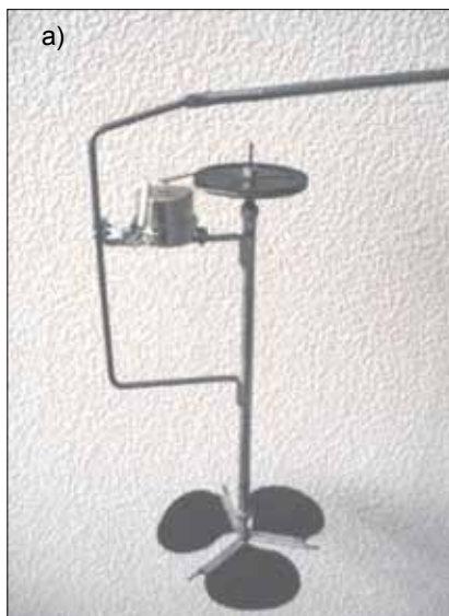
Рис. 4. Фото діючої моделі хвильової енергетичної установки (а) та схема автоматичного ввімкнення/вимкнення світлосигнального елемента (світлодіода) (б)
