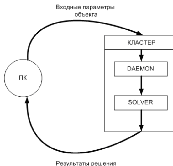
Рисунок 2. Схема работы удаленного модуля решателя
