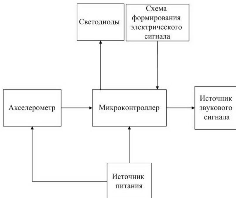
Рисунок 1. Структурная схема прибора
