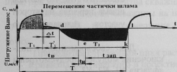
Рис. 2. Графическое отображение картины перемещения шлама для случая 3 б
