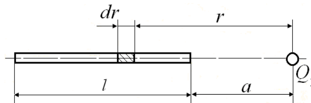
Рисунок 13 – Визначення потенціалу d\varphi в точці А
