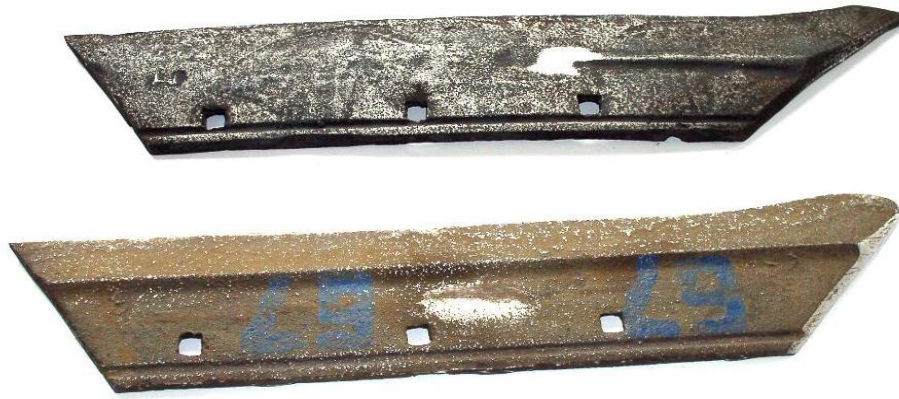
Рисунок 4 – Лемехи с различной конфигурацией ребра жесткости.
