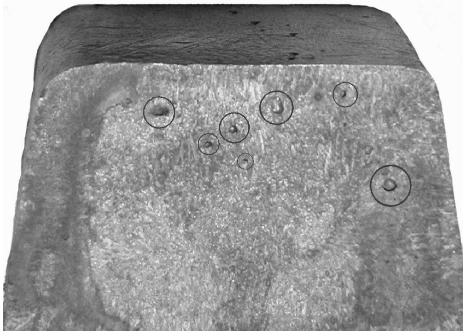
Рисунок 2 – Дефекты внутренней структуры в бруске трапециевидного сечения, который получен на разливочной машине
