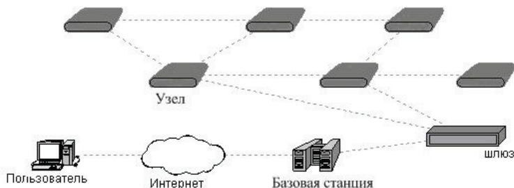
Рисунок 1 – Обобщенная схема беспроводной сенсорной сети
