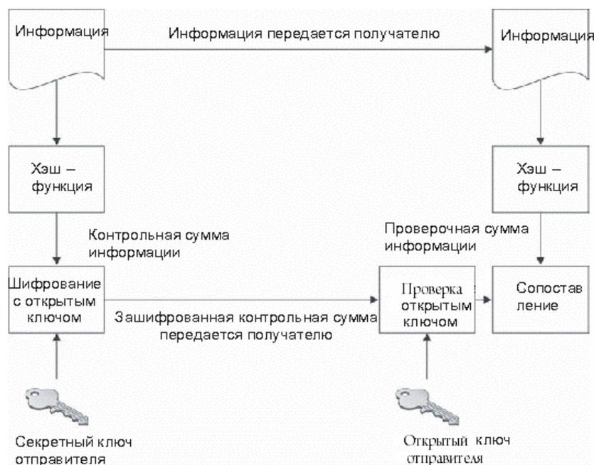
Рисунок 1 – Функционирование цифровых подписей основанных на асимметричных алгоритмах
