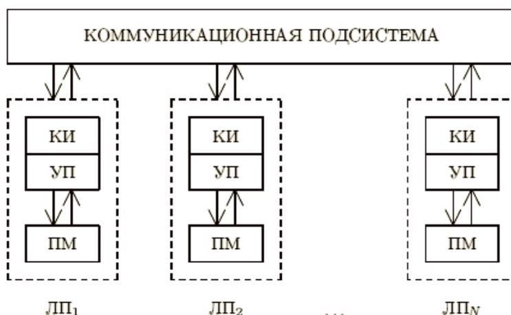
Рис. 1. Схема выполнения распределенной модели: ЛП — логический процесс, ПМ — подмодель, УП — управляющая программа, КИ — коммуникационный интерфейс.
