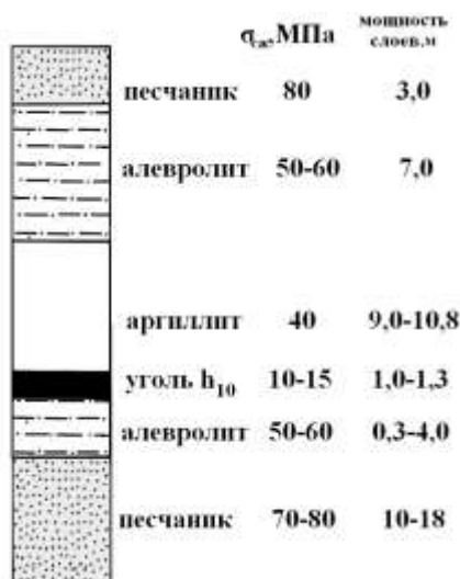
Рис. 4 – Структура боковых пород конвейерного штрека 2-й западной лавы пласта h_{10} шахты им. М. И. Калинина
