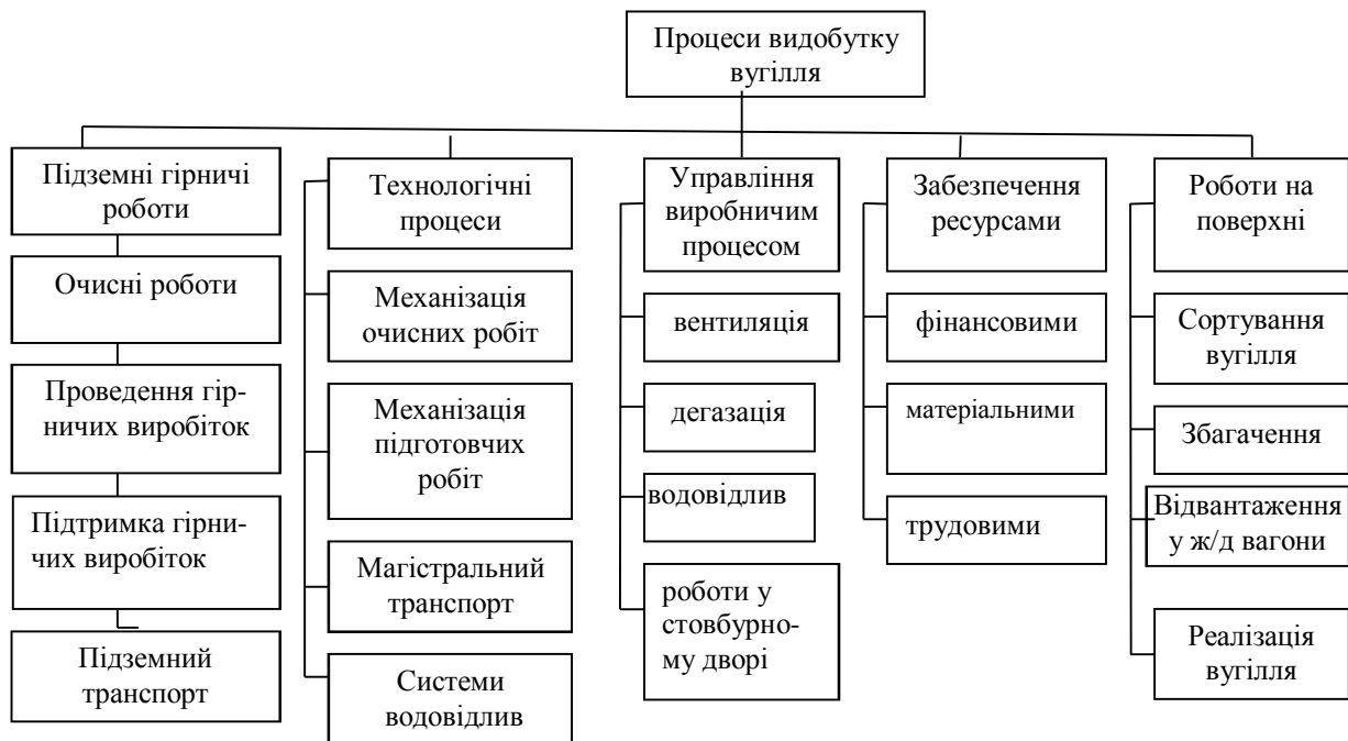
Рис. 1. Функції виробничих процесів видобутку вугілля.
