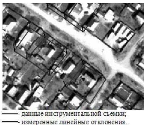
Рис. 1. Пример измеренных линейных отклонений на опорных точках
