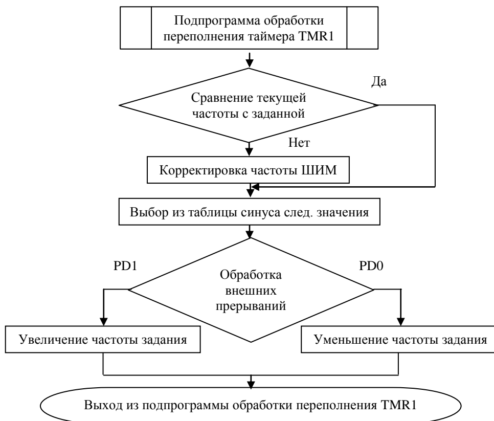
Рисунок 4.2 – Блок-схема алгоритма программы реализации синусоидальной ШИМ
