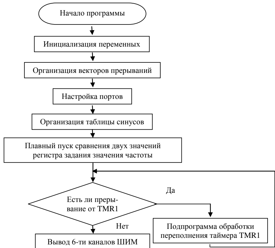
Рисунок 4.1 – Блок-схема алгоритма программы реализации синусоидальной ШИМ
