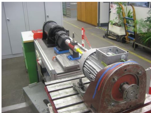
Рисунок 5 – Стенд для вимірювання зубцевого реактивного моменту M_Z СДПМ з вбудованими магнітами
