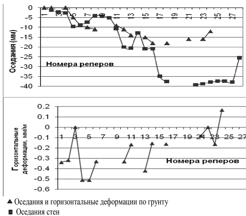
Рис. 7. Оседания и горизонтальные деформации стен и грунта вдоль фасада по ул. Артема
