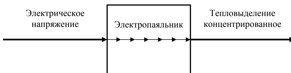
Рис. П1.3. «Вход – выход» электропаяльника
