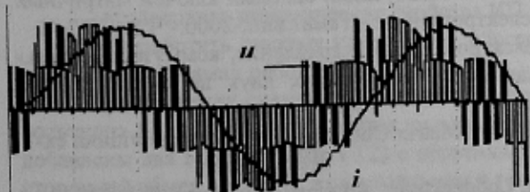
Рисунок 7 - Осциллограмма напряжения и тока фазы МП при частоте 40Гц
