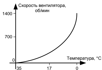
Рис. 1. График зависимости скорости вращения вентилятора от температуры
